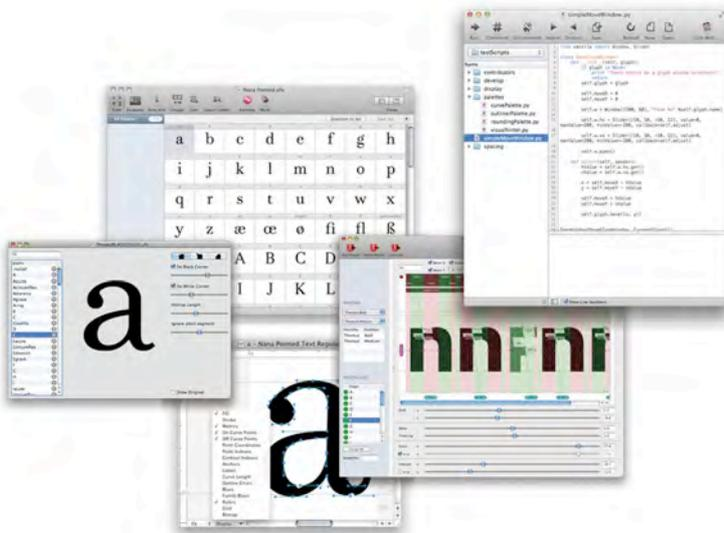
**Ilustración 4. Producción de la fuente desde la sintaxis del lenguaje de programación y comprobación de resultados gráficos en la aplicación Robofont**
