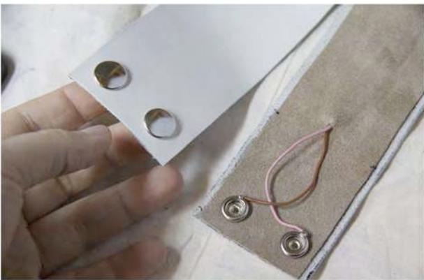
**Fig. 6 Detalle del sistema de unión de las tiras luminosas al infrarrojo al collar del vestido.**
