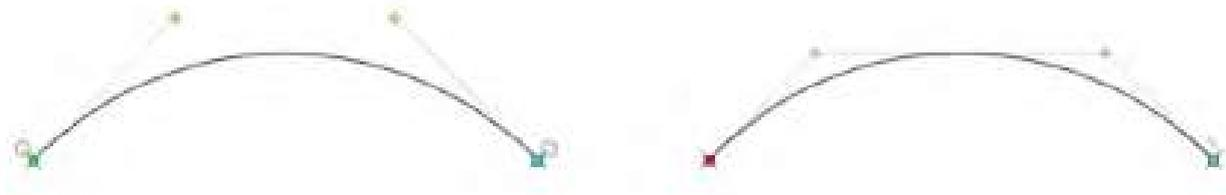
**Ilustración 3. Izqda.: curva tipo Postscript; dcha.: curva tipo TrueType**
